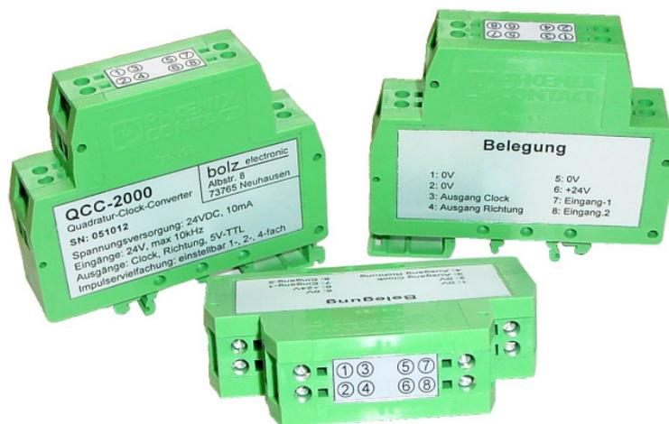
Konverter, erzeugt aus Encoder-Signalen Zähl- und Richtungsimpulse.
